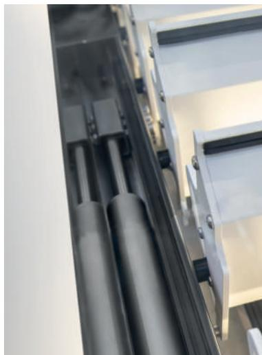
Instaladas con motores lineales eléctricos de 2500 N sincronizados. Un diseño e instalación eléctrica totalmente aislada del agua que garantiza una mayor protección al exterior, con un IP 66 en todos los componentes para reforzar la máxima seguridad y durabilidad del producto. *Se puede controlar a través dispositivos móviles Smartphones o tablets.*
