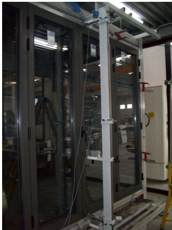
Foto N.º7. Detalle de la posición de los transductores.
