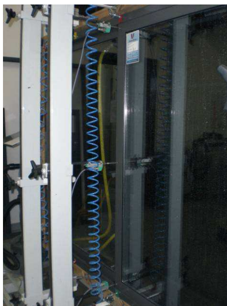
Foto N°.6. Detalle de la posición de los transductores.
