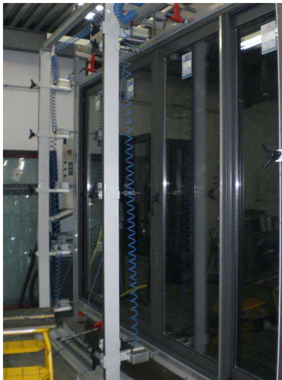
Foto N°.8. Detalle de la posición de los transductores.
