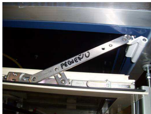
Foto N°8. Detalles de compás y de carga con galipius 2 F1449.
