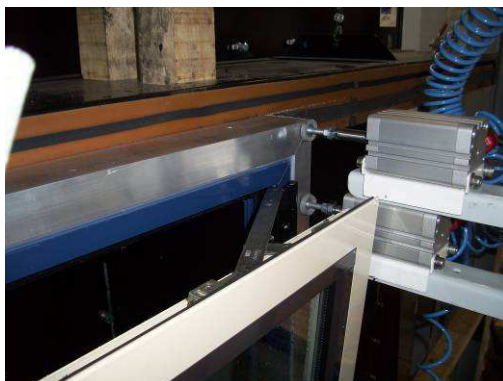
Foto N°10. Detalles de compás y de carga con galiplus 3 F1452B.
