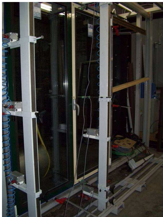
Foto N°6. Detalle de la posición de los transductores.
