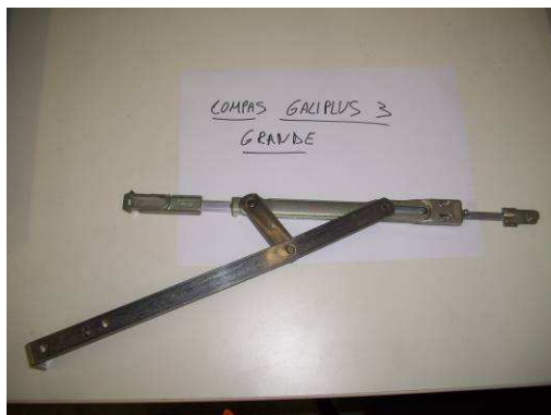
Foto N.º 9. Detalles de compás y de carga con galiplus 3 F1452C.
