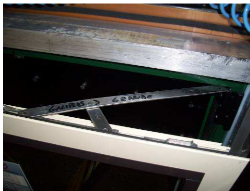
Foto N.º 9. Detalles de compás y de carga con galiplus 3 F1452C.
