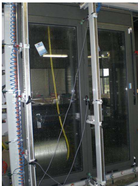
Foto N°.9. Detalle de la posición de los transductores.
