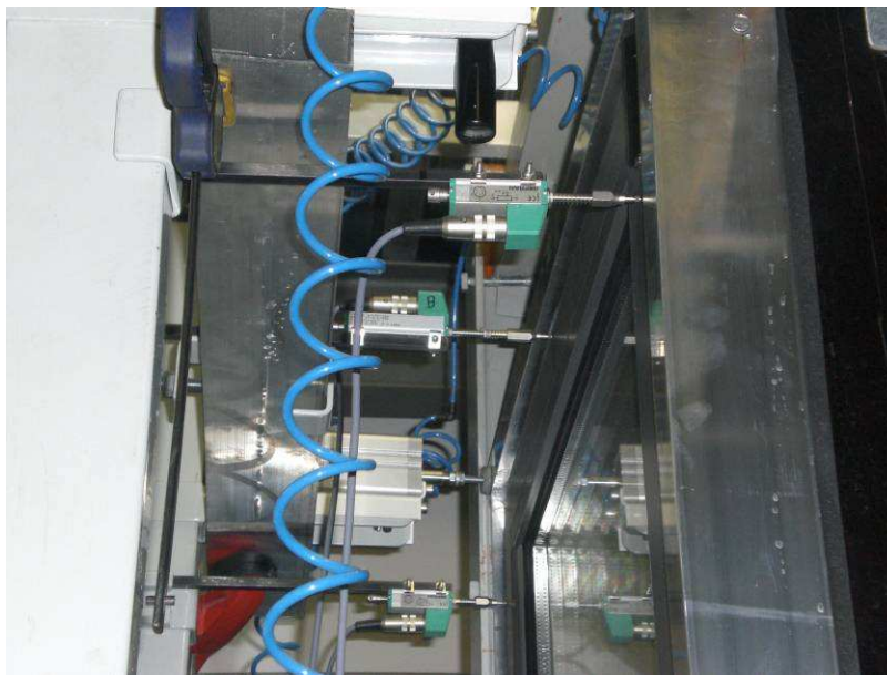
Foto N°7. Detalle de la posición de los transductores.
