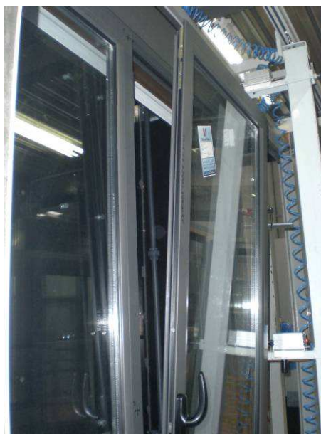
Foto N°.2. Detalle de apertura oscilobatiente.
