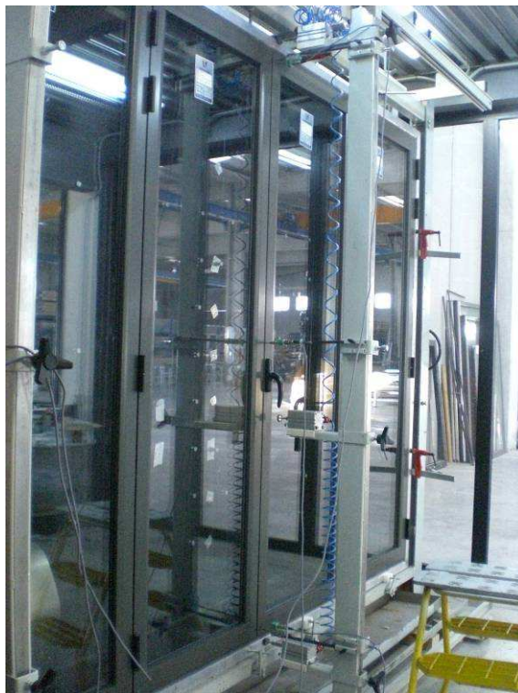
Foto N°7. Detalle de la posición de los transductores.
