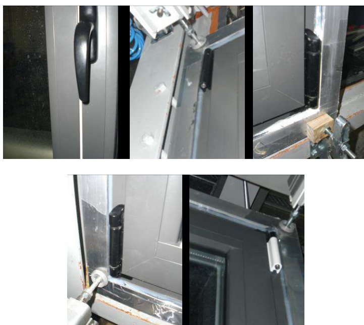
Foto N°.2. Detalle de manilla y bisagras.
