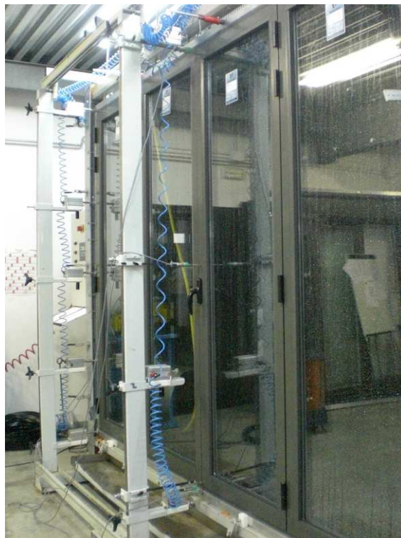
Foto N°6. Detalle de la posición de los transductores.
