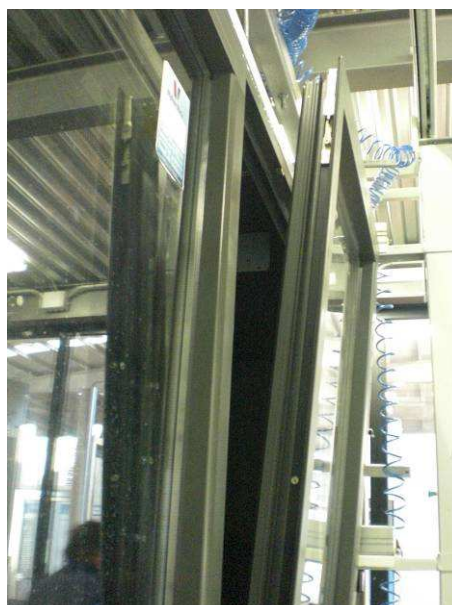
Foto N°.2. Detalle de apertura oscilobatiente.
